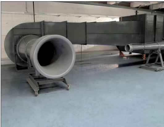
Saugseitiger Kammerprüfstand zur Messung der aerodynamischen Ventilator Kennlinie nach ISO 5801 für Axial- und Radialventilatoren
