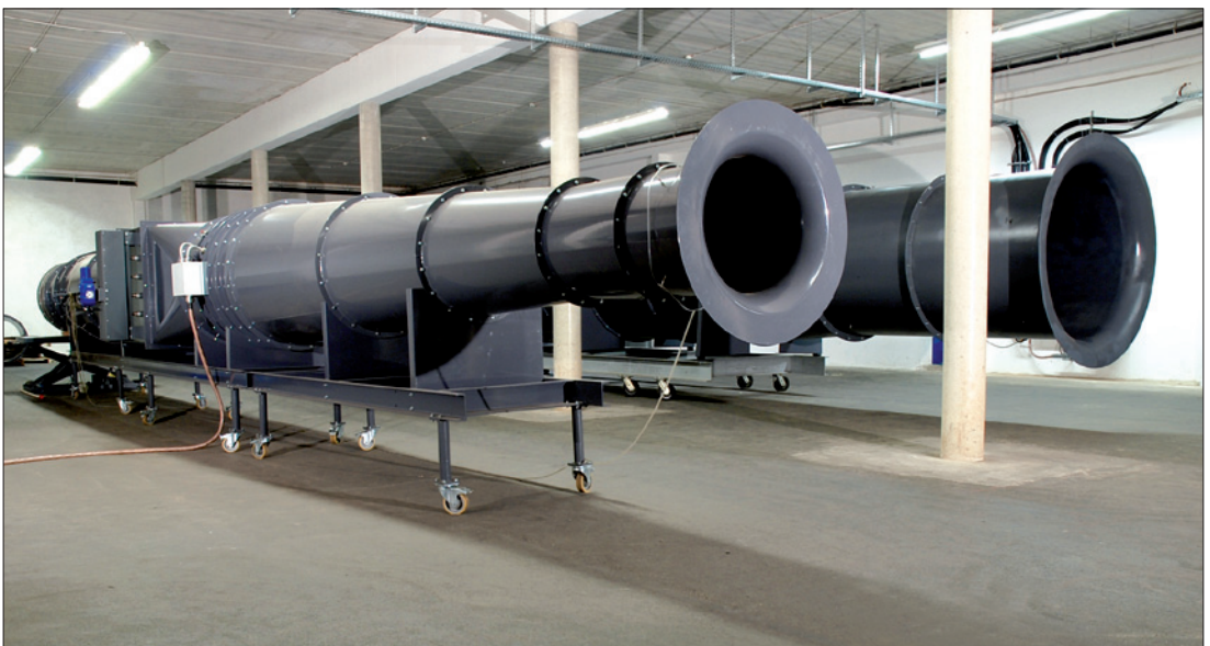
Saugseitige Rohrprüfstände zur Messung der aerodynamischen Ventilator Kennlinie nach ISO 5801 für Axialventilatoren unterschiedlicher Durchmesser
